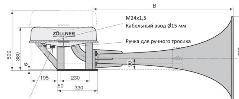
Внутренний диаметр трубы мин. NW12
